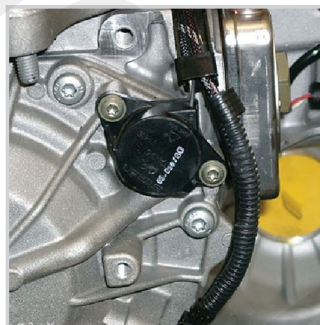
شکل ۳۸. شیر سولنوئیدی جریان مبدل حرارتی روغن.
