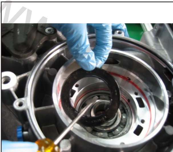
روکش بلبرینگ را بوسیله یک پیچ گوشتی کوچک بیرون آورید
