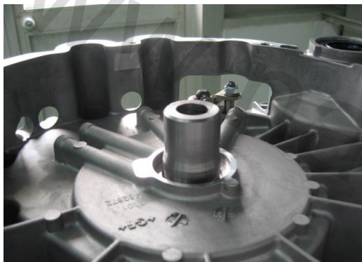
ابزار مخصوص را روی شفت ورودی قرار دهید (102971)
