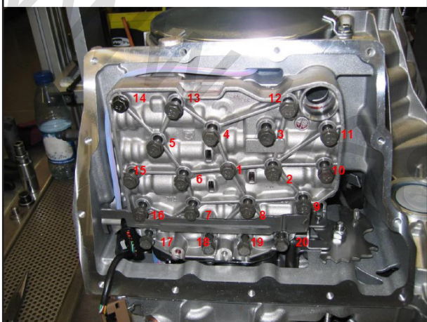
ترتیب باز و بست پیچ ها
