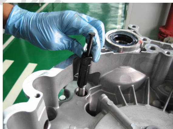
ابزار مخصوص 102970 را روی شفت قرار دهید
