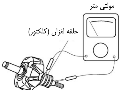
شکل ۳-۲۶: کنترل مدار بسته بین رینگ روتور و هسته آهنی یا بین رینگ و محور روتور
