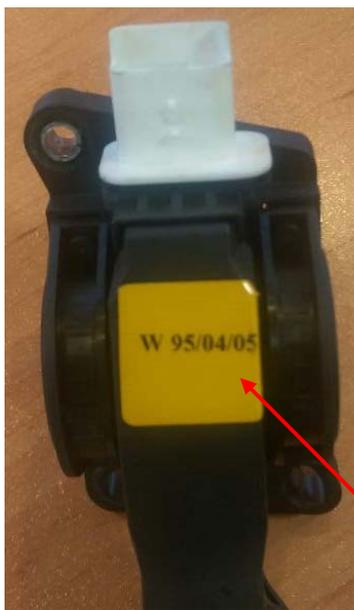
۳- سپس اقدام به کنترل پدال گاز برقی گردد. پدال گاز بهینه دارای یک لیبل زرد رنگ از تاریخ تولید 95/04/05 به بعد می باشد. در صورت عدم مشاهده مشخصه مذکور، اقدام به تعویض قطعه پدال گاز به شماره فنی ۰۳۲۰۳۰۳۴ نمایید.
