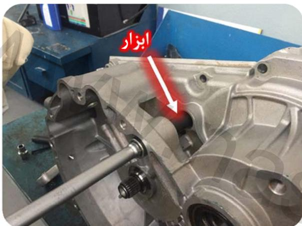
ابتدا اهرم شفت انتخاب وضعیت را خارج نموده و ابزار مخصوص را روی شفت قرار داده به نحوی که شفت وارد سوراخ ابزار شود. با استفاده از آچار بکس، ابزار را بچرخانید تا رزوه‌های کلگی ابزار به داخل کاسه نمد نفوذ کرده و آن را در بر بگیرد و ابزار در جای خود محکم شود. پیچ کوچک و بلند روی ابزار را به کمک یک آچار مناسب بچرخانید تا کاسه نمد مستعمل از جای خود حرکت کرده و نهایتاً خارج شود.
